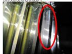
Rachadura da roda de engrenagem - eixo intermediário
